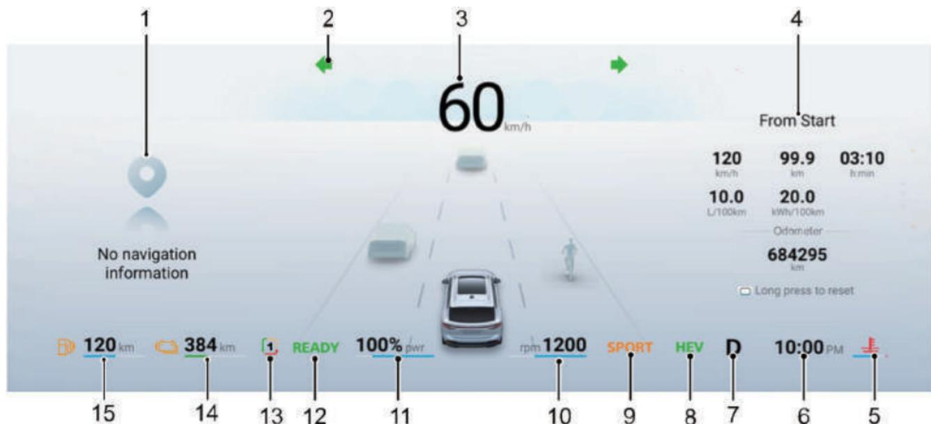
**Hinweis:**Das Instrumentenpaket verfügt über mehrere Anzeigemodi, die im Unterhaltungsdisplay eingestellt werden können.
