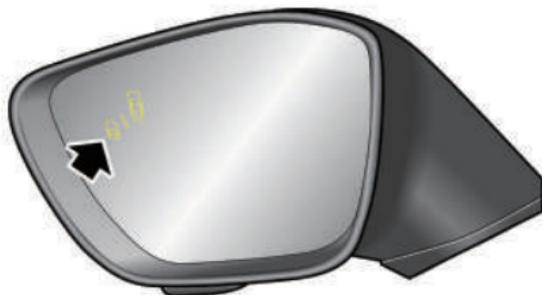
Bei Kollisionsgefahr leuchtet die Warnlampe an der entsprechenden Stelle auf. In diesem Fall, wenn die Türöffnung fortgesetzt wird, blinkt die Warnlampe mit akustischem Alarm.
