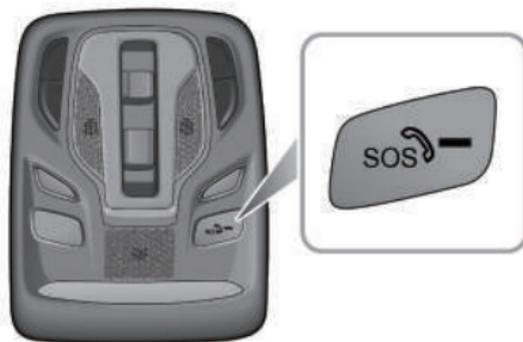
Der Notruf (eCall) führt einen Selbsttest durch, wenn der Startschalter in der 'ON/RUNNING/READY'-Position ist. Die LED-Statusanzeige auf der SOS-Taste leuchtet, wenn keine Systemfehler vorliegen. Die LED-Statusanzeige erlischt oder bleibt an, nachdem sie langsam geblinkt hat, wenn ein Fehler erkannt wird. Eine entsprechende Fehlermeldung wird auf dem Instrumentendisplay angezeigt.
