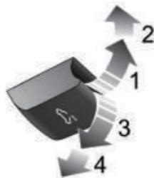
Schieben Sie den Schiebedachglasschalter in die Position (1) und halten Sie ihn gedrückt. Das Schiebedach wird gekippt. Der Schiebedachbetrieb kann jederzeit durch Loslassen des Schalters gestoppt werden.
