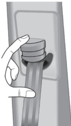
Bitte befolgen Sie die folgenden Anweisungen, um den Höhenversteller des oberen Ankerpunkts des Sicherheitsgurts korrekt zu verwenden:
