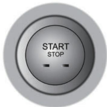
Der schlüssellose 'Start/Stop'-Schalter befindet sich auf dem Armaturenbrett und ist ein Druckknopfschalter. Um das System zu bedienen, muss sich der Smart Key im Auto befinden.
