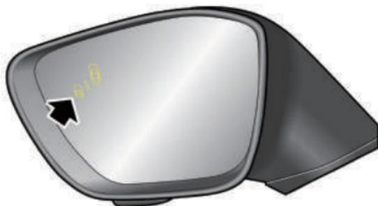
Wenn beim Rückwärtsfahren ein Risiko besteht, leuchtet die Warnleuchte auf der entsprechenden Seite und das System hat einen Alarmton. Wenn der Fahrer keine Sicherheitsmaßnahmen ergreift, wird das System eine Notbremsung durchführen.
