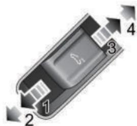
Schieben Sie den Schiebedachglasschalter nach hinten auf Position 3 und halten Sie ihn gedrückt. Dadurch kann das Schiebedach manuell geöffnet werden. Die Schiebedachbewegung kann jederzeit durch Loslassen des Schalters gestoppt werden.
