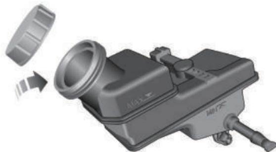
***Hinweis: Bremsflüssigkeit beschädigt lackierte Oberflächen. Wenn Sie versehentlich Bremsflüssigkeit auf die lackierte Oberfläche verschütten, verschütten Sie sofort mit einem saugfähigen Tuch aufsaugen und den Bereich mit Wasser oder Autoshampoo waschen.***
