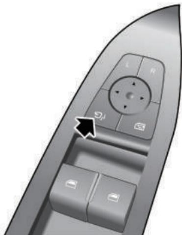
Drücken Sie die Taste (Pfeil) am Kombischalter auf der Fahrerseite, der Außenrückspiegel wird elektrisch eingeklappt. Durch erneutes Drücken der Taste werden die Spiegel in ihre ursprüngliche Position zurückgebracht.
