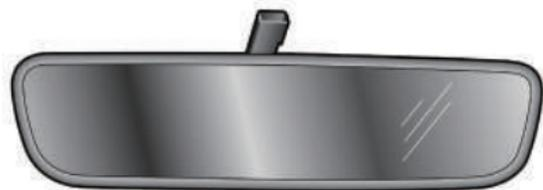
Wenn sich der Startschalter im grünen Lichtzustand befindet, wird die automatische Abblendfunktion automatisch eingeschaltet, wenn die Scheinwerfer eines nachfolgenden Fahrzeugs den Fahrer blenden könnten.
