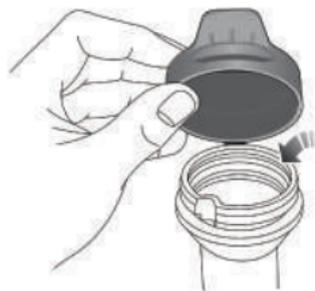
**Hinweis:** Verwenden Sie **KEINE** Frostschutz- oder Säurelösung (wie z.B. den Verdüner von Essig) im Flüssigkeitsbehälter – Frostschutzmittel beschädigt den Lack, während Säurelösung den Waschmotor beschädigt.
