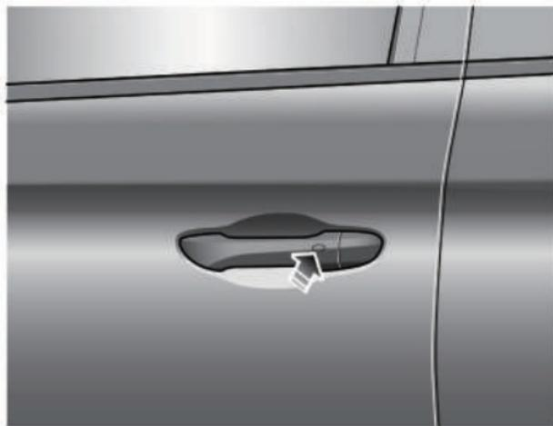
**Hinweis:** Halten Sie den Abstand zwischen dem Smart Key und dem Türgriff innerhalb des 1,5 m Bereichs, um die Türen mit der schlüssellosen Funktion zu verriegeln und zu entriegeln.
