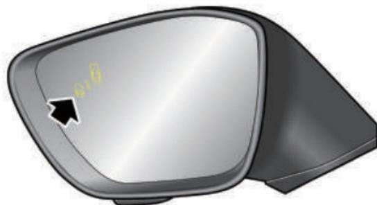
Während der Fahrt (bei einer Geschwindigkeit über 10 mph (15 km/h), wenn das System ein Fahrzeug im toten Winkel des Rückspiegels Ihres Fahrzeugs oder ein Fahrzeug erkennt, das sich von hinten auf der benachbarten Spur nähert, leuchtet die Warnlampe auf der entsprechenden Seite auf. Wenn die Blinkleuchte auf derselben Seite eingeschaltet ist, blinkt die Warnlampe und warnt den Fahrer, dass es gefährlich ist, den Spurwechsel fortzusetzen.
