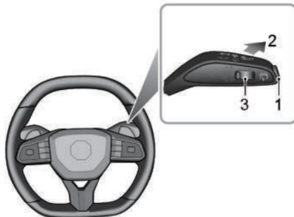
Der Heckscheibenwischer und die Waschanlage arbeiten nur, wenn der Startschalter in der ACC/ON/RUNNING/READY Position ist.
