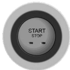
Der schlüssellose START/STOPP-Schalter befindet sich in der Blende rechts von der Lenksäule und ist ein Druckknopfschalter. Um den Schalter zu betätigen, muss sich der Smart Key im Fahrzeug befinden.
