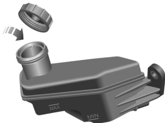
**Nota:** El líquido de frenos dañará las superficies pintadas. Si accidentalmente derrama el líquido de frenos sobre una superficie pintada, absorba el derrame inmediatamente con un paño absorbente y lave el área con agua o champú para coches.
