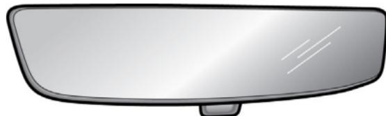
Mueva la palanca a la base del retrovisor interior para cambiar su ángulo, con el fin de lograr la función antideslumbramiento. La visibilidad normal se restablece volviendo a tirar de la palanca hacia atrás.
