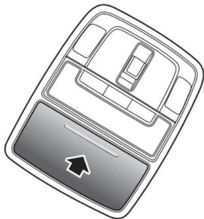
El portagafas se encuentra en la proximidad de las luces de cortesía delanteras. Presione el panel (como indica la flecha) y coloque las gafas en el portagafas después de abrirlo. Cierre el portagafas cuando no esté en uso.
