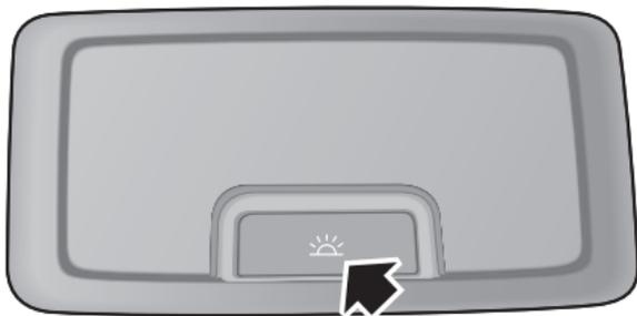
Presione el interruptor (indicado con una flecha) para iluminar las luces de cortesía traseras, presione de nuevo para apagarlas.
