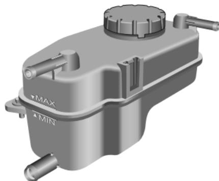
Se recomienda que el sistema de refrigeración se revise semanalmente cuando esté frío y con el vehículo estacionado en un suelo nivelado. Si el nivel de refrigerante está por debajo de la marca "MIN", retire la tapa del depósito de expansión del refrigerante y añada refrigerante, pero el nivel no debe ser superior a la marca "MAX".
