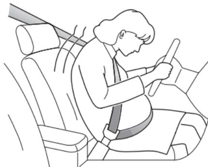
La sección diagonal del cinturón de seguridad debe pasar a través del pecho del modo habitual. La sección del regazo debe pasar por debajo de la barriga, baja y ceñida a los huesos de la cadera. No coloque NUNCA el cinturón sobre, ni encima, de la barriga.
