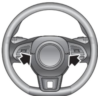
Pulse el área del botón de la bocina (indicada con una flecha) en el volante para accionar la bocina.
