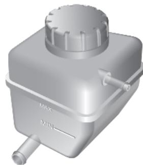
El sistema de refrigeración debe comprobarse semanalmente en frío y con el vehículo sobre un suelo nivelado. Abra el capó y compruebe el nivel de refrigerante. Si el nivel de refrigerante se sitúa por debajo de la marca "MÍN.", abra el tapón del depósito de expansión correspondiente y añada refrigerante. El nivel de refrigerante no debe superar la marca "MÁX.".
