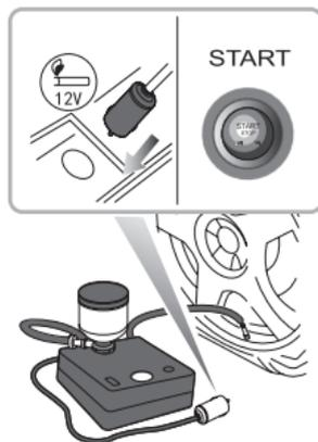
**Nota:** Para evitar descargar la batería, es recomendable mantener la transmisión en P y el vehículo en modo READY.
