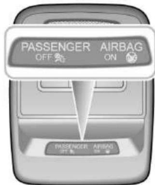
El testigo de estado del airbag del acompañante se encuentra en el conjunto de luces del techo del habitáculo. La forma del conjunto de luces varía dependiendo de la configuración del vehículo.
