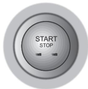
El interruptor de ARRANQUE/PARADA sin llave está situado en el salpicadero, a la derecha de la columna de dirección, es un interruptor tipo pulsador. Para accionar el interruptor, la llave inteligente debe encontrarse dentro del vehículo.
