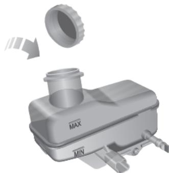
**Nota:** El líquido de frenos daña las superficies pintadas. En caso de derrame accidental de líquido de frenos sobre superficies pintadas, elimínelo inmediatamente con un paño absorbente y lave la zona con agua o jabón de lavado para coches.
