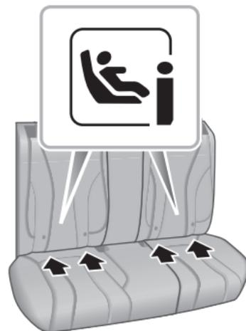
3 Para sujetar la correa de fijación superior del sistema de retención infantil, introduzca la correa por debajo del reposacabezas y fíjela en el gancho de anclaje, prestando atención a no darle vueltas. Si no utiliza los anclajes inferiores ISOFIX, realice el montaje siguiendo las instrucciones del fabricante del sistema de retención infantil con los cinturones de seguridad.
