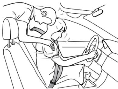
Con el vehículo en movimiento, la velocidad de los ocupantes es idéntica a la del vehículo. En caso de colisión frontal o de frenada de emergencia, el vehículo podría detenerse y los ocupantes continuar su trayectoria hasta entrar en contacto con un objeto detenido. Este objeto podría ser el volante, el salpicadero, el parabrisas u otros elementos.
