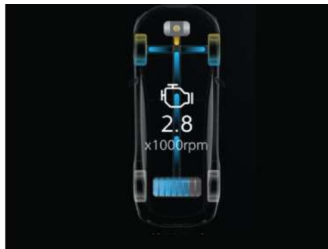
Izklop motorja pri regeneraciji energije
