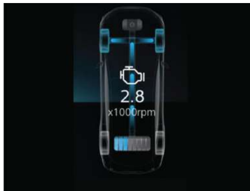
Izklop motorja pri izključno električni vožnji
