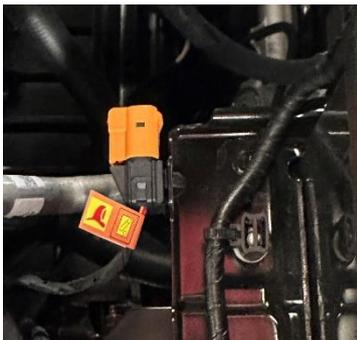
In Notfällen kann das Hochvolt-System durch Entfernen der manuellen Betriebstrennvorrichtung isoliert werden (Master-Sicherheitsgerät). Befindet sich unter der Motorhaube auf der linken Seite.
