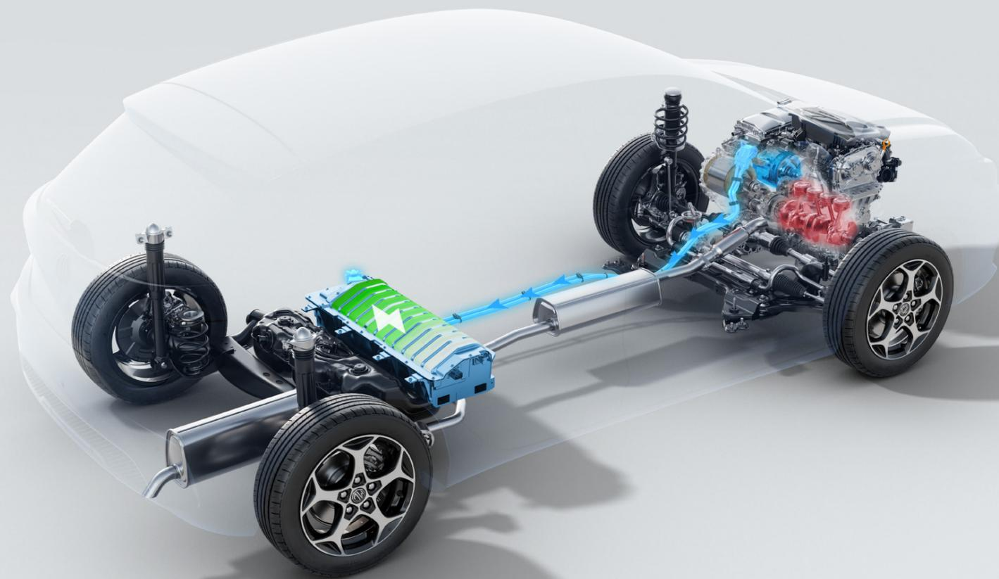
**Hybride-parallèle** : les deux moteurs, électrique et thermique, fonctionnent de concert pour propulser le véhicule. C'est idéal pour une conduite dynamique et des performances optimales.
