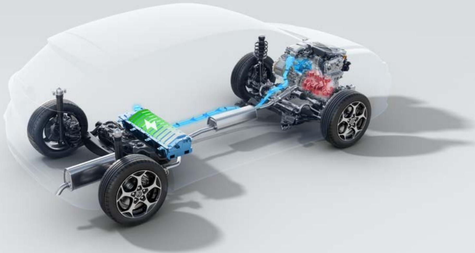
**Hybride-parallèle** : les deux moteurs, électrique et thermique, fonctionnent de concert pour propulser le véhicule. C'est idéal pour une conduite dynamique et des performances optimales.
