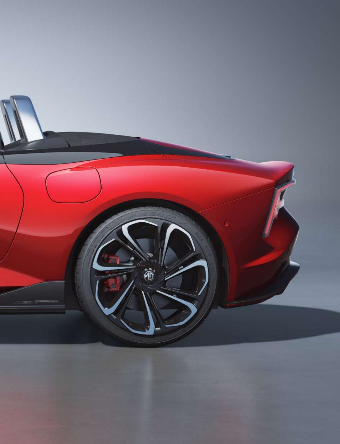
L'arrière du MG Cyberster adopte un profil « Kammback », c'est-à-dire avec une seule cassure verticale surplombée d'un élégant spoiler. Ce design ne rehausse pas seulement l'attrait visuel du véhicule, il minimise également les turbulences de l'air, ce qui améliore considérablement l'aérodynamisme et garantit une meilleure adhérence des roues arrière. La signature lumineuse arrière, inspirée du célèbre drapeau anglais, allie technologie de pointe et design iconique.
