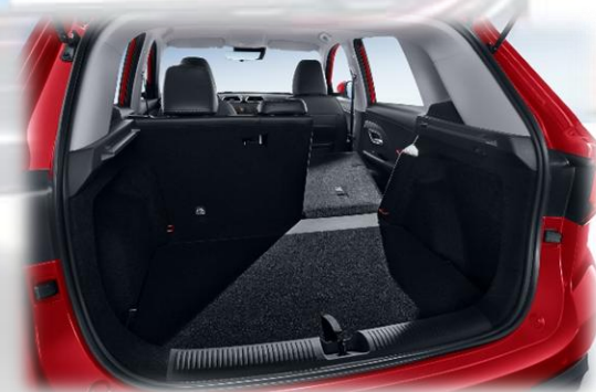
Tavaratila (litraa, takapenkit ylhäällä / kaadettuna): 358 / 1298
